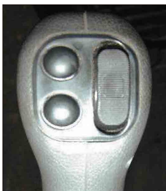
Optionaler Steuerhebel mit Tasten und Schiebeschalter
